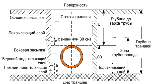
Рис. 3 Устройство траншеи
